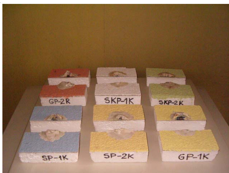
Figure 4. Echantillons sectionnés soumis au test pour mesurer la pénétration de l'eau de pluie sous l'action du vent. On peut observer que l'eau n'a pas pénétré à l'intérieur des échantillons
